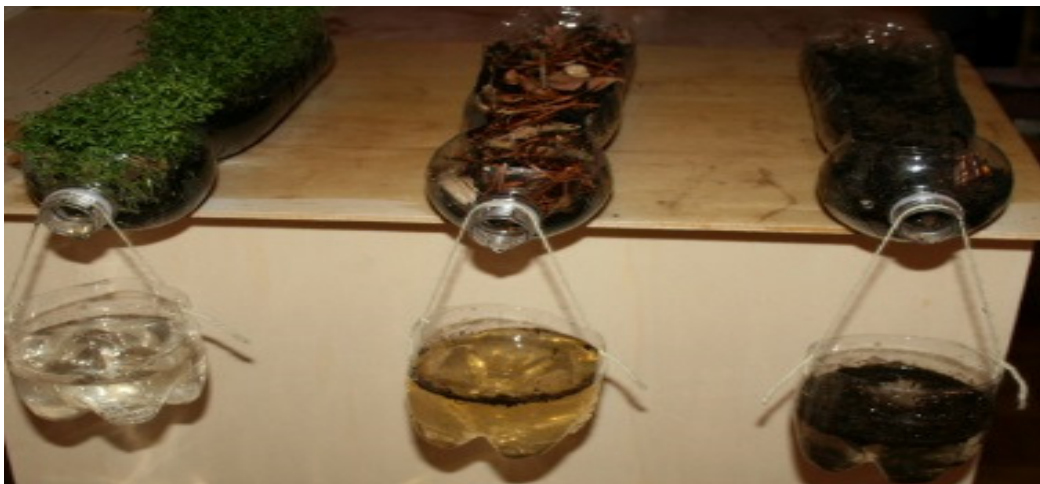
Figura 9- Funcionamento do experimento de Filtração Biológica da água.
